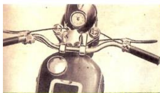
Lenkeransicht mit Tachometer im Scheinwerfer
